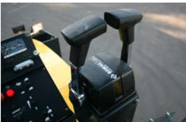
Joysticks de operação para as vibroacabadoras de esteiras. Possibilita mudança de direção no próprio eixo de giro.
