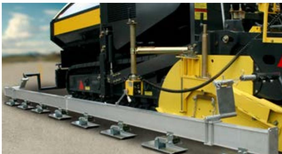
O sensor longitudinal é conectado à um acessório de contato, o esqui. Quanto maior o esqui, maior será a compensação das possíveis irregularidades existentes, melhorando o IRI (índice de irregularidade longitudinal).
