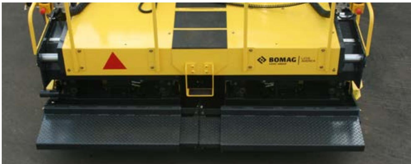
Mesa compactadora com abertura hidráulica mínima. A largura de pavimentação pode ser reduzida ainda mais com o uso de redutores internos.
